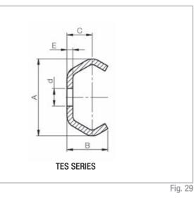
В Е WEIGHT Reference Α С d Screw (mm) code (mm) (mm) (mm) type standard (mm) (kg) TES 26 26 14 9,5 6,5 2,5 M5 (ISO 7380) 0,80 TES 40 39,5 21 9 3 M8 (ISO 7380) 1,55 13 Tab. 14
